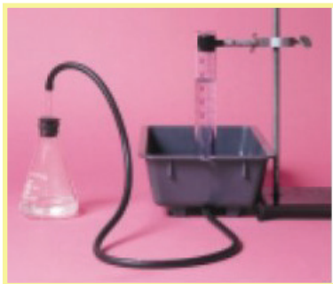
Şekil 4.2. Zaman içinde ayrılan gaz halindeki ürünün hacminin ölçülmesi
