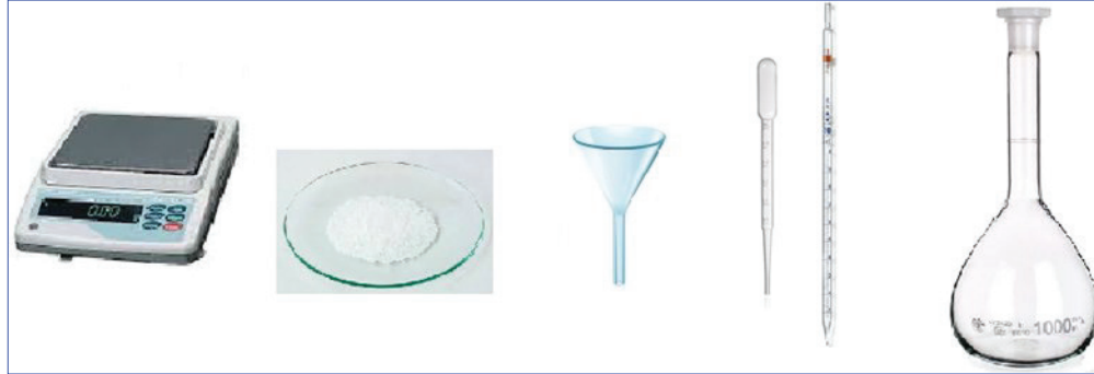
Şekil. 2.7. Belirli bir konsantrasyonda çözelti hazırlamak için gerekli ekipman
