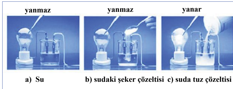
Şekil 2.9. Işık, elektrotlar saf suya (a) ve sudaki şeker çözeltisine (b) daldırıldığında yanmaz, ancak (c) suda tuz çözeltisine daldırıldığında yanar.
